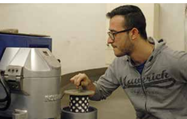
Une cuvette est déposée dans l'installation de coulage à vide.
