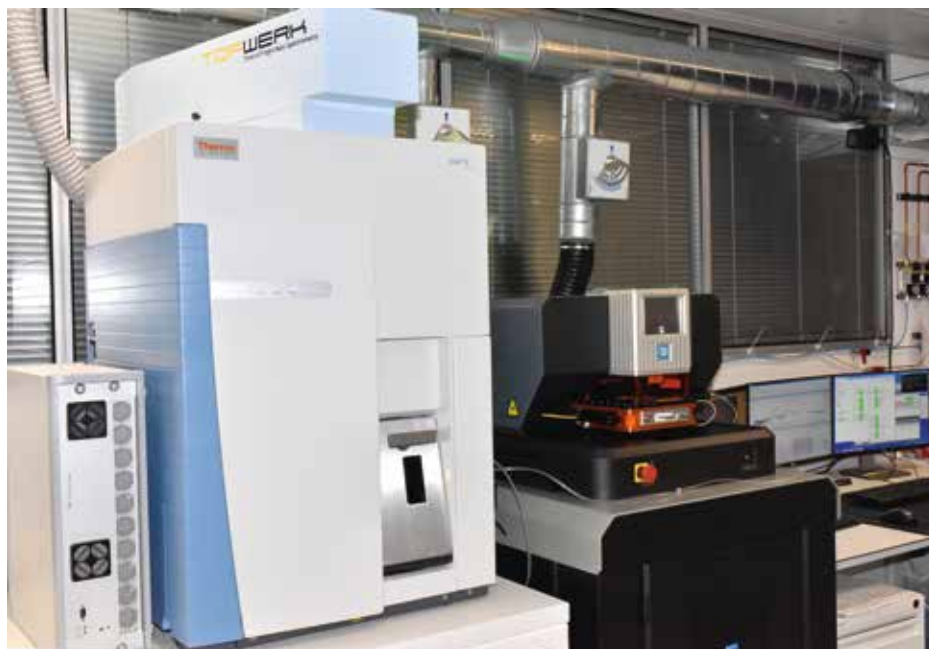
Das Gemtof-Setup am SSEF besteht aus zwei Einheiten, dem ICP Time-Of-Flight-Massenspektrometer (links) und dem Laserablations-System (ultravioletter Laser 193nm).
