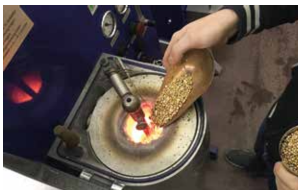
Les métaux précieux sont versés dans l'installation de coulage.
