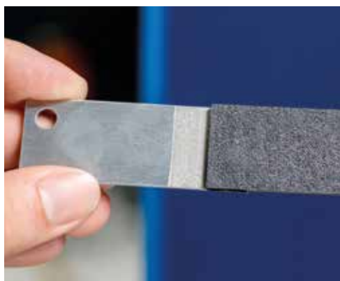
Soudure métal-plastique réalisée au NanoFoil. A gauche l'aluminium, à droite le polymère thermoplastique. La zone blanche au centre a été structurée au laser. Photo: TUM
