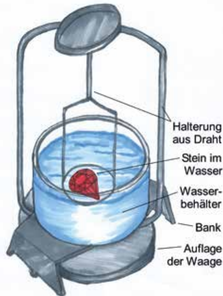
Vorrichtung zur Bestimmung der Dichte nach dem archimedischen Prinzip.
